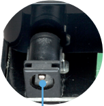
Schaltnetzteil: 12 -24 V DC Ausgangsstrom- mindestens: 3A
