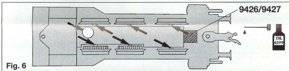
An der markierten Stelle kann der **Schaltmagnet 9426/9427** eingebaut werden (Fig. 6).
