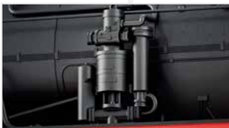
Speisepumpe Bauart Knorr KT1-250 mit Tolkien-Steuerung
