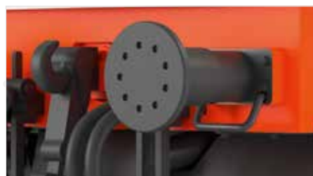
Pufferbohle mit freistehenden Puffergriffen
