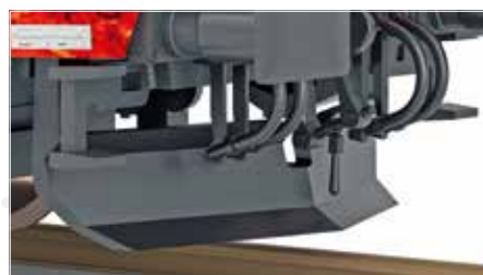
Schienenräumer am Chassis angesteckt
