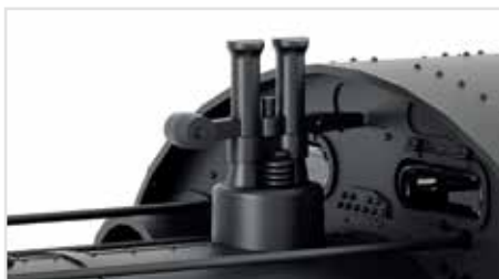
Sicherheitsventil der Bauart Ramsbottom
