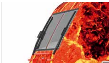
Separat angesetzte Scheibenwischer
