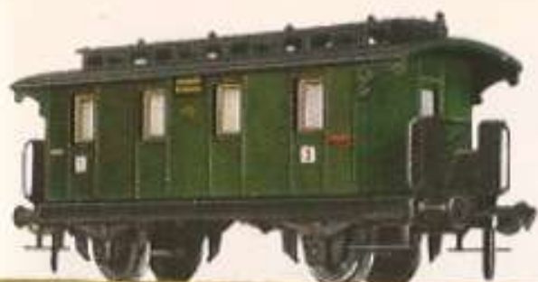
1400 DM 6.— Personenwagen 3. Klasse der ehemaligen Preußischen Staatsbahn Modell des CiPr86. Länge über Puffer: 103 mm. Fahrgestell Zinkdruckguß, Oberteil Plastik.
