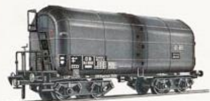
1497 DM 8.— Großraum-Kesselwagen „Ksl 3504“ der DB zum Transport von Heizöl, LüP: 140 mm. ● Bausatz siehe Seite 27.
