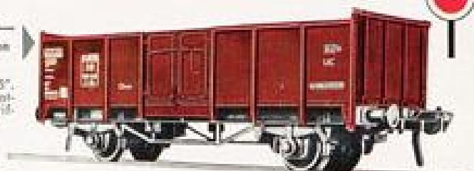
1457 DM 5,— EUROP-O-Wagen der DB. LfP: 112 mm. Bauart „Omn 55“. Wagenkasten rot-braun, Beschriftung teilweise ohne Füllung.
