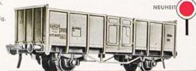
1457 K DM 5,50 EUROP-O-Wagen der SNCF. LfP: 112 mm. Bauart „TOW“, Wagenkasten grau-schwarz, Beschriftung teilweise, mit Kohlenfüllung.
