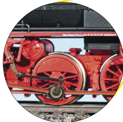
Die Treibachse ist zu Gunsten von Stromabnahme und Kurvenläufigkeit stark höhen- und seitenverschiebbar. Das Schutzblech darüber fehlt ebenso wie die Sandfallrohre. Etwas seltsam wirkt die runde Scheibe an der Gegenkurbel.
