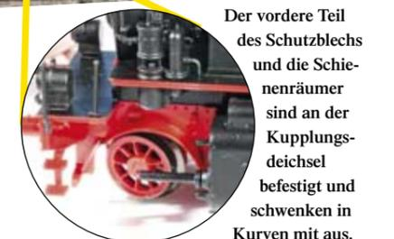
Der vordere Teil des Schutzblechs und die Schienenräumer sind an der Kupplungsdeichsel befestigt und schwenken in Kurven mit aus.
