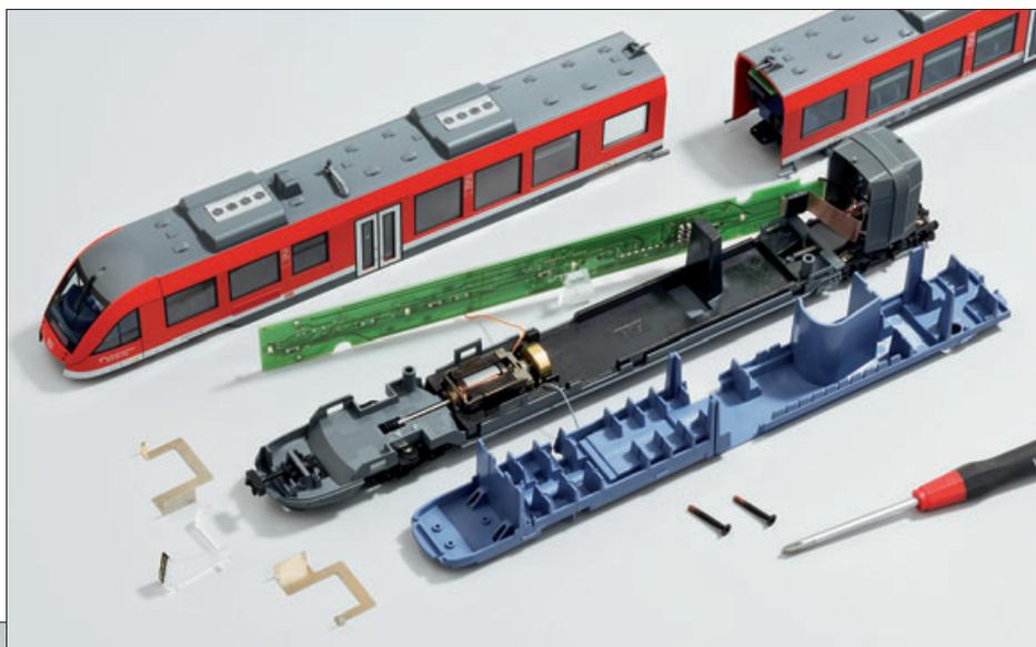
Links: Die Technik des Fleischmann-Modells ist leicht zugänglich: Motor mit Schwungmasse, Antrieb auf ein Drehgestell, je ein Haftreifen pro Achse (diagonal versetzt), Stromabnahme von allen Rädern. Man beachte auch das korrekt detaillierte Dach.
