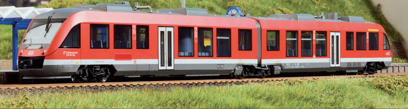
Bereits im EK 8/2001 berichteten wir ausführlich über Alstoms neue Generation Leichter Innovativer Nahverkehrs-Triebwagen – genauer über den Typ LINT 41, die zweiteilige Version des modular aufgebauten Fahrzeugs mit dieselhydraulischem Antrieb aus Alstoms CORADIA-Familie.
