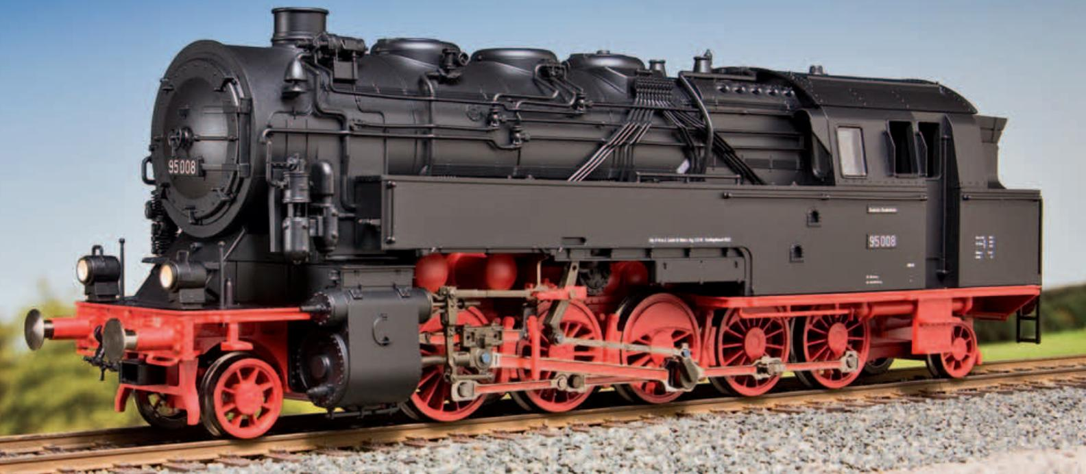
Die Steuerung des Modells ist – wie bei Fleischmann üblich – perfekt nachgebildet und in einer Mischbauweise aus Kunststoff und gestanzten Blechteilen hergestellt. Auch die Verbindungsrohre zwischen den beiden Wasserkästen hat Fleischmann nicht vergessen.
