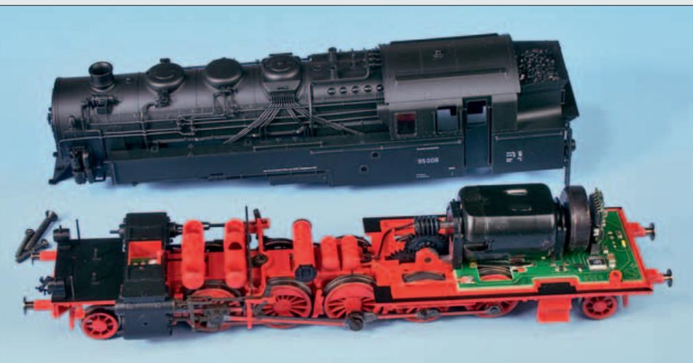
Oben: Wie überhaupt die gesamte Modellkonstruktion der 95er, ist vor allem die Technik des Modells perfekt durchdacht. Sie darf von anderen Modellbahnherstellern gerne als Vorbild genommen werden! Nach dem Lösen von drei Schrauben lässt sich das Gehäuse einfach und ohne zu verkleben nach oben abnehmen und gibt den Zugriff auf das Getriebe, den Fünfpol-Motor und die sechspolige Digitalschnittstelle frei.
