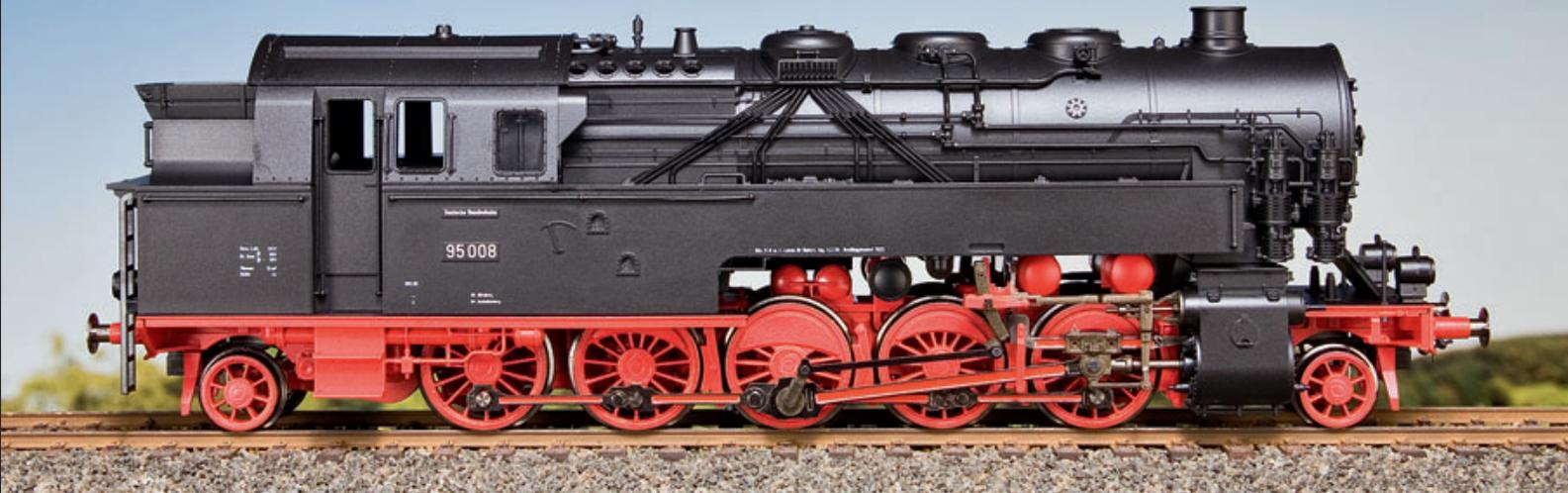
Oben: Vorbildgerecht hat Fleischmann die Lok mit zwei Luftpumpen ausgestattet. Beachtenswert ist auch das Leitungsgeflecht am Kessel, das aus einem einzigen Spritzling besteht und sehr realistisch wiedergegeben wurde. Die auf der Pufferbohle montierten Lampen sind allerdings etwas zu tief und passen nicht so recht zum guten Erscheinungsbild des Modells.
