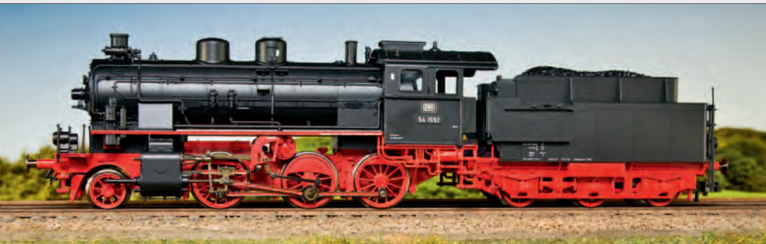
Oben: Die Seitenansicht des Modells zeigt die hohe Lage des Kessels und den freien Durchblick über dem Rahmen. Die Lokräder mit den feinen Speichen und den niedrigen Spurkränzen tragen viel zum guten Eindruck der Lok bei. Die Radnabe der Vorlaufachse ist etwas zu groß geraten.
