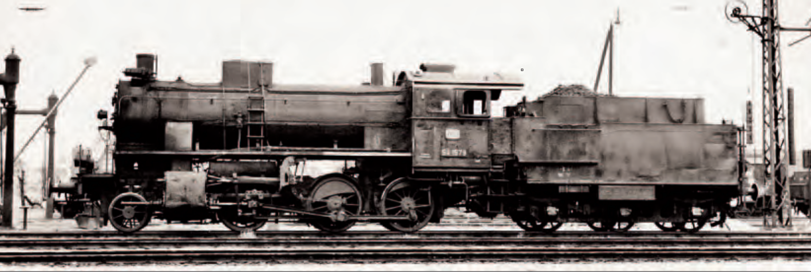
54 1579 (Maffei 5128, Baujahr 1920) am 28. Mai 1960 im Bw Nürnberg Rbf. Die Lok besaß zum Aufnahmezeitpunkt keinen Vorwärmer, wie der freie Platz vor der Treibachse zeigt. Der Aufstieg zum Sandkasten erfolgte über eine Leiter, spätere Ausführungen besaßen Trittstufen. Aufnahme: Walter Hanold, Archiv jsk
