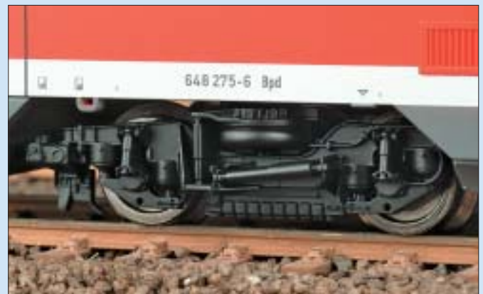
Luftfederung, Schlinger- und Stoßdämpfer, Magnetschienenbremse und weitere Details am vorderen Drehgestell
