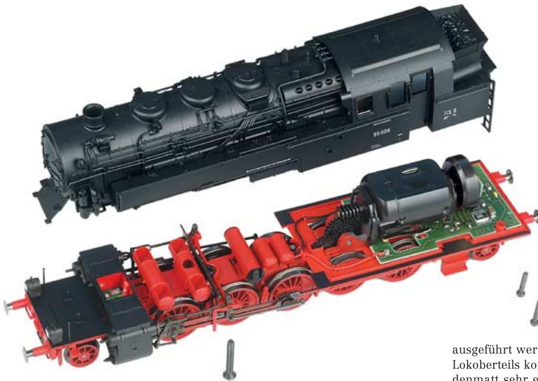
Das Gehäuse lässt sich nach dem Lösen von drei Schrauben ohne jegliches Hakeln nach oben abheben. Im Führerhaus ist der kleine, aber kräftige fünfpolige Motor gelagert, der über ein Schnecken-Stirnrad-Getriebe mit gut gewählter Übersetzung den vierten Kuppelradsatz antreibt. Dieser trägt auch die Haftreifen.
