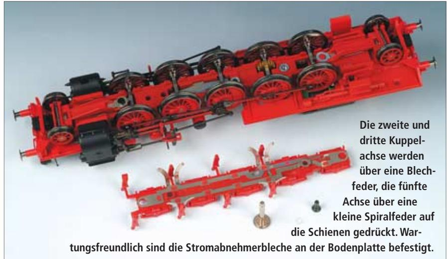
Die zweite und dritte Kuppelachse werden über eine Blechfeder, die fünfte Achse über eine kleine Spiralfeder auf die Schienen gedrückt. Wartungsfreundlich sind die Stromabnehmerbleche an der Bodenplatte befestigt.
