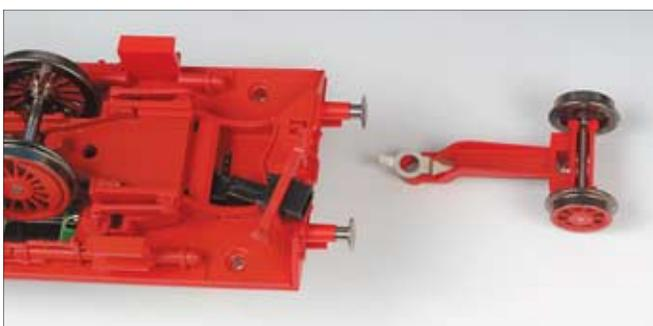
tig isolierten Vor- und Nachlaufachsen. Der elektrische Anschluss erfolgt über Kontaktbleche direkt zu der darüber liegenden Leiterplatte, auf der die gesamte Elektrik vereint ist.
