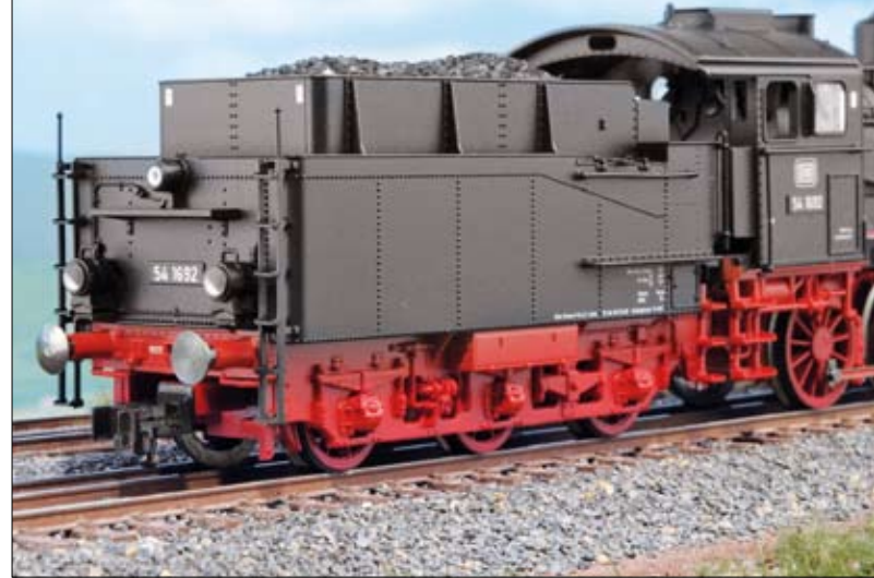
Der neukonstruierte 3 T 18,2-Tender von der Rückseite betrachtet. Aufbau wie Fahrwerksblende zeigen eine Fülle von Details.
