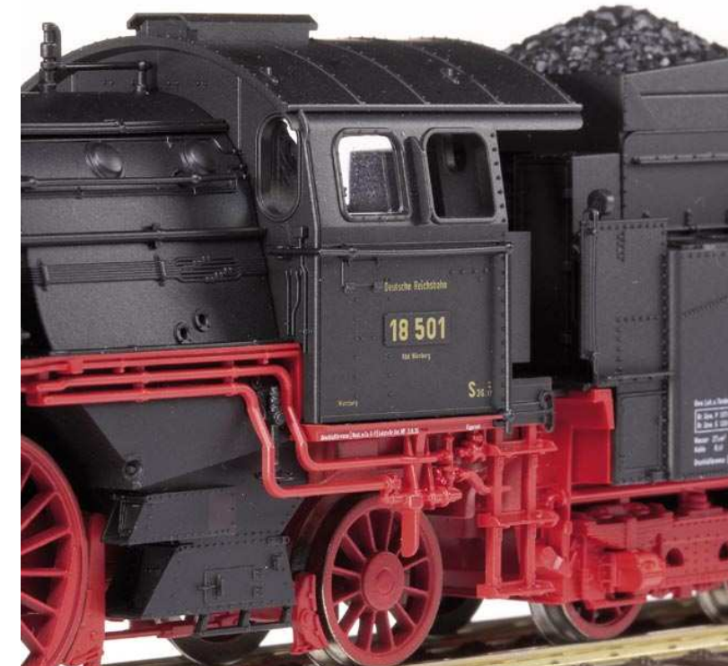
Absolut vorbildgerecht: die messingfarbene Beschriftung und ein Führerhaus, dessen Seitenwände im Bereich der Fenster abgeschrägt sind
