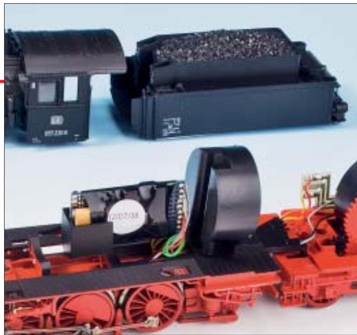
Der ummantelte Sounddecoder, der von ESU stammt, wurde vor dem Lautsprecher in der Lok untergebracht.
