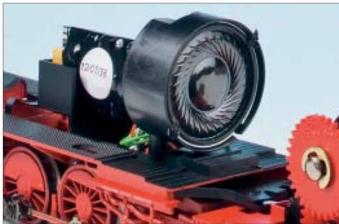
Der von einem Resonanzgehäuse umschlossene Lautsprecher befindet sich bei 055 220 im Bereich der Stehkessel-Rückwand.
