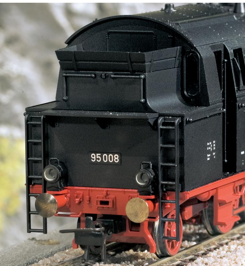
An der Rückansicht fallen die schräg nach oben abgehenden Aufsatzbretter des Kohlentenders und die freistehenden Lampen auf.
