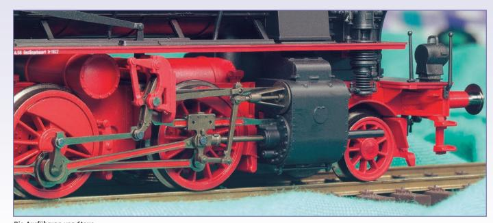
Die Ausführung von Steuerung und Radsätzen zählt zur Großserien-Spitze. Endlich gibt es auch Kolbenstangen-Schutzrohre.
