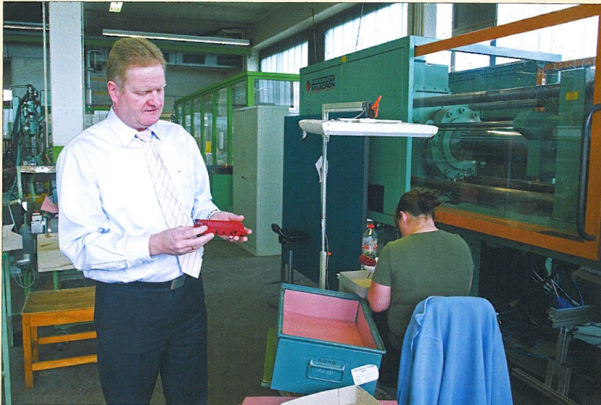
Frisch aus der Form präsentiert Jürgen Singer, Geschäftsführer in Heilsbronn, das noch unlackierte Kunststoffgehäuse eines Fleischmann-Klassikers, der Baureihe 03.10 der DRG in H0.
