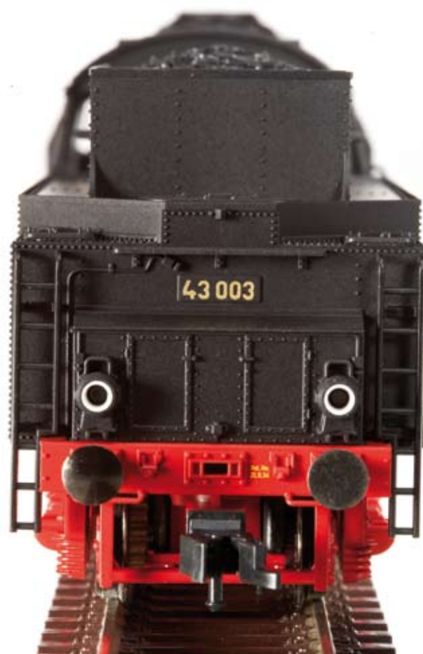
Als Tender dient der 2'2' T 32 in genieteteter Bauart.
