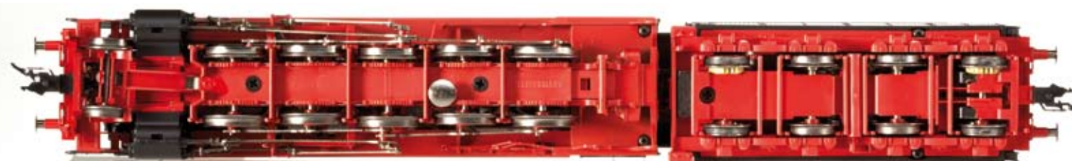
In der Seitenlage offenbart die Lok ihren bewährten Antrieb auf die beiden äußeren Tenderachsen und den anachronistischen Schaltpilz.
