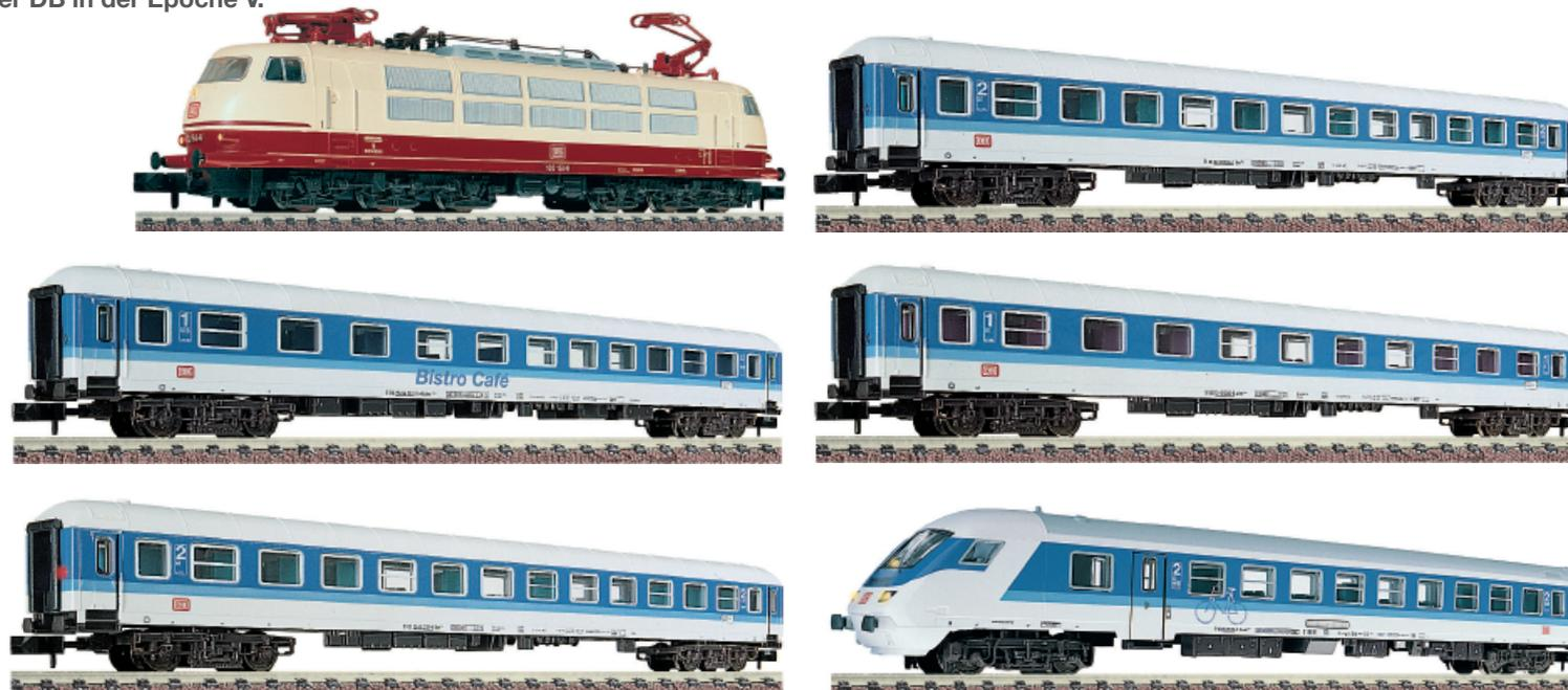
1 Ellok BR 103.1 mit Steckschnittstelle, 1 InterRegio-Wagen 1. Kl., 1 InterRegio-Wagen 2. Kl., 1 InterRegio-Wagen 2. Kl. mit elektronischer Zugschlussbeleuchtung, 1 InterRegio-Wagen „Bistro-Café“, 1 InterRegio-Steuerwagen 2. Kl. mit Fahrradabteil, Spitzenbeleuchtung und roter Zugschlussbeleuchtung.
