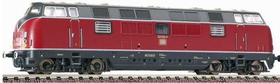
Weiterentwicklung der V 200. 1962 wurde die erste Lok an die DB geliefert. Die Universallok leistet 2.700 PS. Damit kann sie unterschiedlichste
