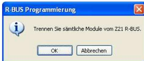
Wenn alle Module von der R-BUS Buchse der Z21 getrennt sind, betätigen Sie „OK“.
