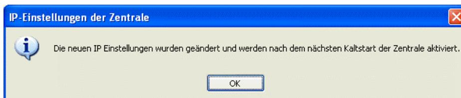
**Wichtig: die neue IP-Adresse wird in der Z21 erst nach einem Kaltstart (d.h. Versorgungsspannung entfernen) der Zentrale aktiv!**
