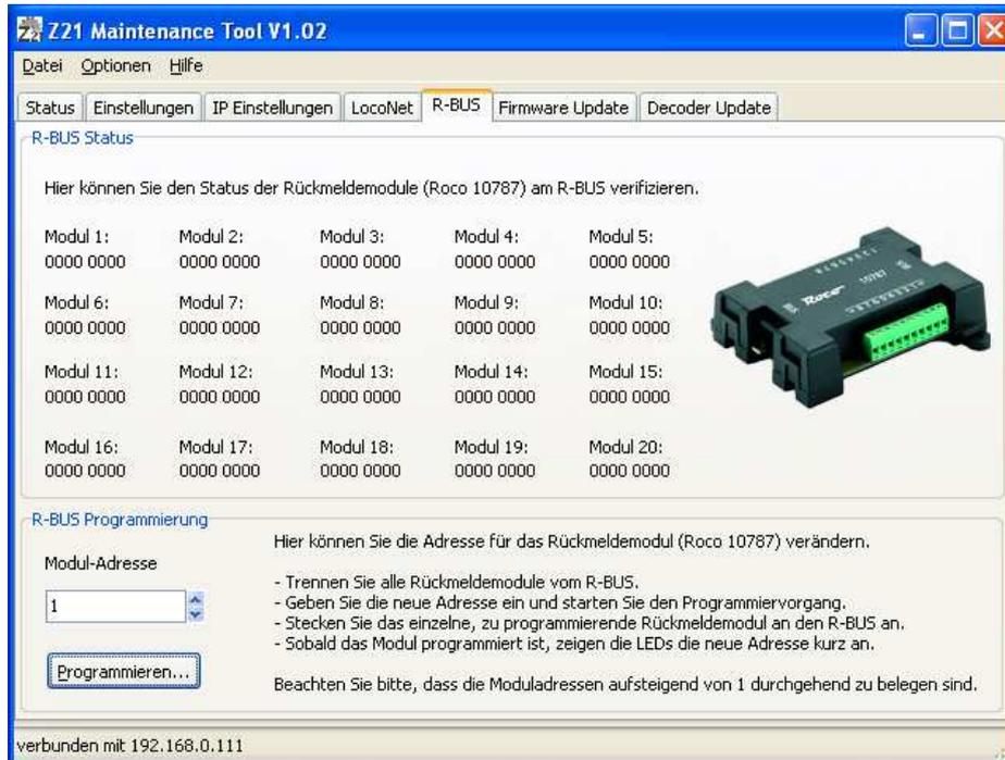
Ein aktiver Rückmeldeeingang wird als unterstrichene Nummer des jeweiligen Einganges des entsprechenden Moduls angezeigt. Ein nicht aktiver Eingang wird als ‚0‘ dargestellt. Außerdem werden Status-Änderungen eines Moduls zur leichteren Erkennung blau eingefärbt.
